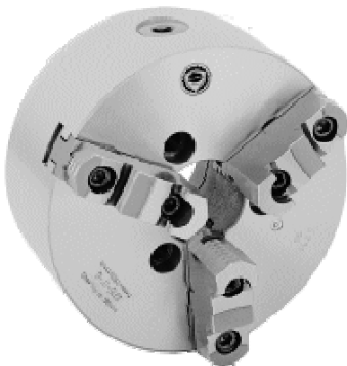
Rys. 4. Uchwyty tokarskie a) uchwyt trójszczękowy samocentrujący, b) uchwyt z niezależnie nastawianymi szczękami - ręczny
