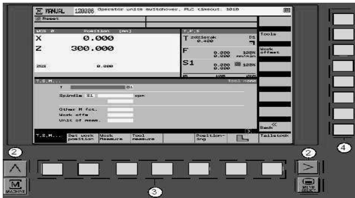
Rys. 9. Widok ekranu sterowania z klawiszami wyboru funkcji ekranowych: 1 – ekran, 2 – klawisze zmiany funkcji ekranowych oraz klawisz wywołania menu maszynowego „Machine” i głównego menu układu sterowania „Menu select”, 3 – klawisze wyboru dolnych funkcji ekranowych, 4 – klawisze wyboru bocznych funkcji ekranowych
